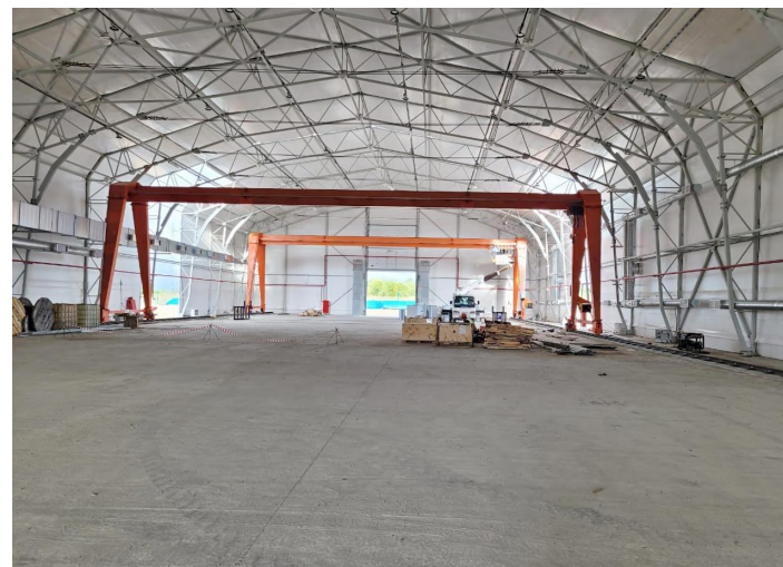
Краны козловые однобалочные грузоподъемностью 6,0 тонн и длиной пролета 24,0 метра для предприятия в Амурской области.
